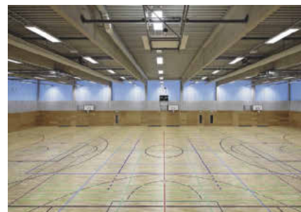
Die lichtstreuende und -durchlässige „Laterne“ ermöglicht eine blendfreie Hallenbelichtung.
